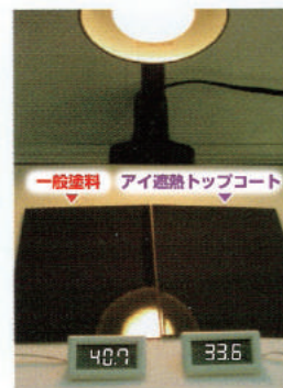
鋼板面に塗装し、レフランプの光を当て、裏面温度を測定
